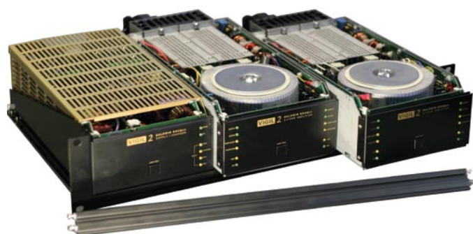
Moduły wzmacniaczowe w jednej ramie z zasilaczem-ładowarką
